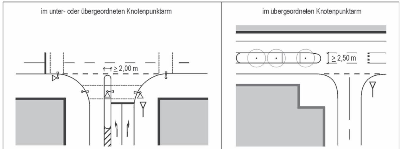
Bild 117: Beispiele für Fahrbahnteiler an signalisierten und vorfahrtgeregelten Knotenpunkten
